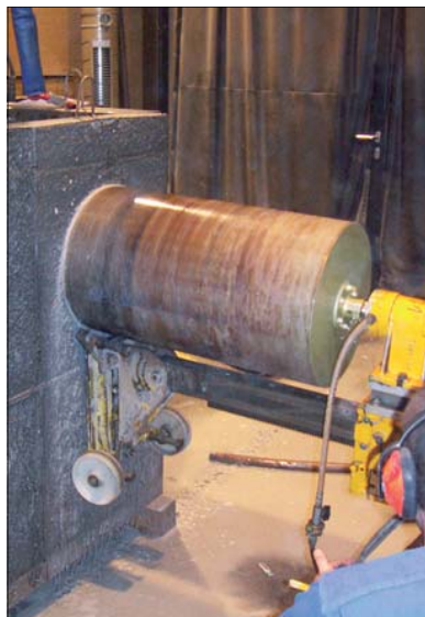
Abb. Prüfmethode mit Schneidbrenner (oben) und Diamantkronenbohrer (rechts)
