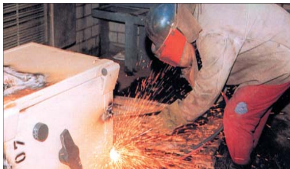
Abb. Prüfmethode mit Schneidbrenner (oben) und Diamantkronenbohrer (rechts)
